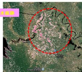
SARデータを使ったダム決壊による浸水域推定結果
