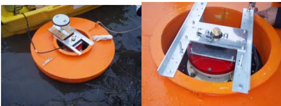
図 2-2-3 ジンバル機構を搭載したフロート
