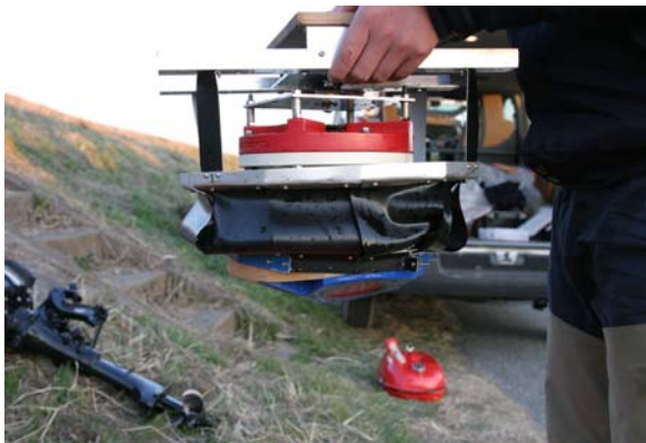
図 2-2-2 作成したジンバル機構
