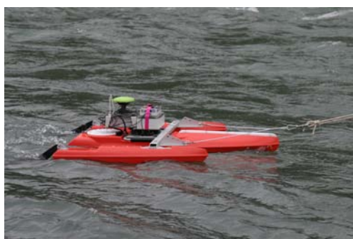
図-4 ADCP 観測に用いた橋上操作艇
