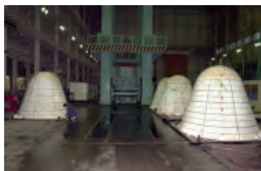
【30MN大型構造部材万能試験機】
