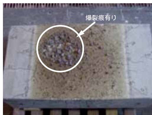
写真-2 実験結果の一例 (呼び強度30N/mm 2 )
