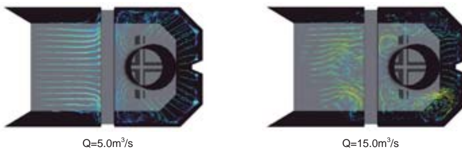
図-2 水面近傍のフローパターン（水深/水位=3250/3350）
