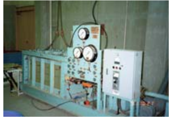
埋設管実験用圧力装置
