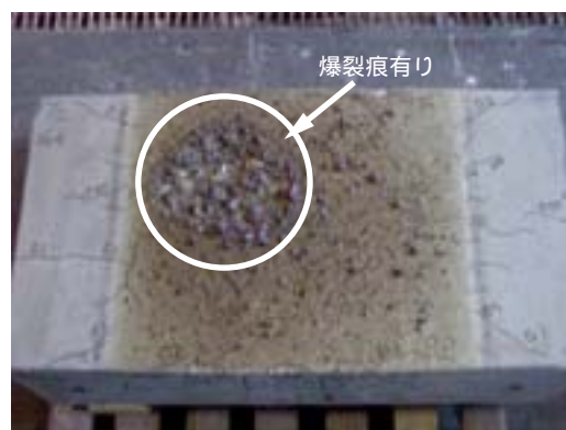
写真-2 実験結果の一例 (呼び強度30N/mm 2 )
