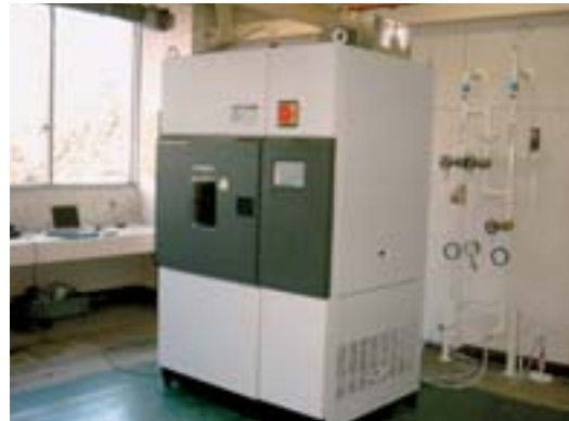
【建設材料劣化シミュレーション実験施設】
