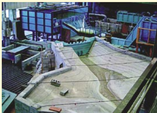
大型模型作成 (ダム)
