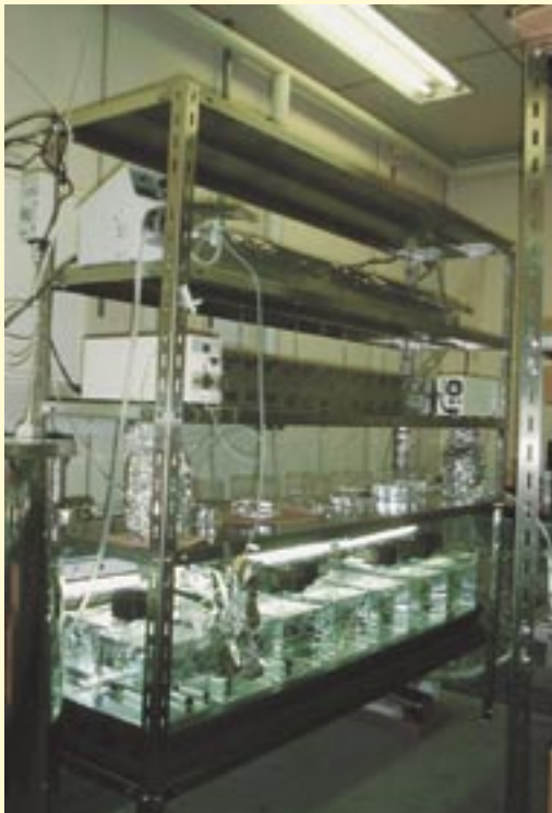
化学物質暴露用魚類試験装置
