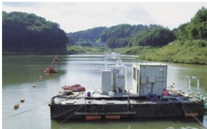
写真-1 底泥からの栄養塩類溶出現地実験（三春ダム）
