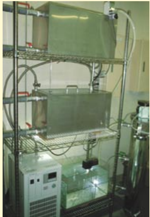
現場設置型流水式試験装置
