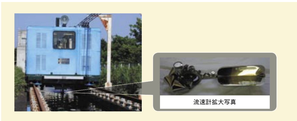
写真-1.4.2 流速検定施設
