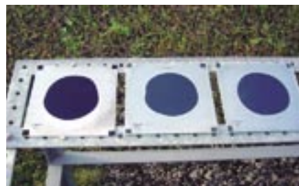
図-2 アスファルトの屋外暴露試験
