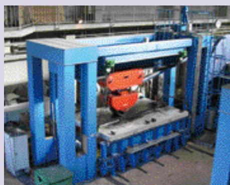
【輪荷重走行試験機】 (道路橋床版の疲労耐久試験)
