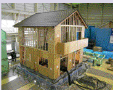
【大型振動台施設】 (非土木技術分野である木造住宅の耐震試験)
