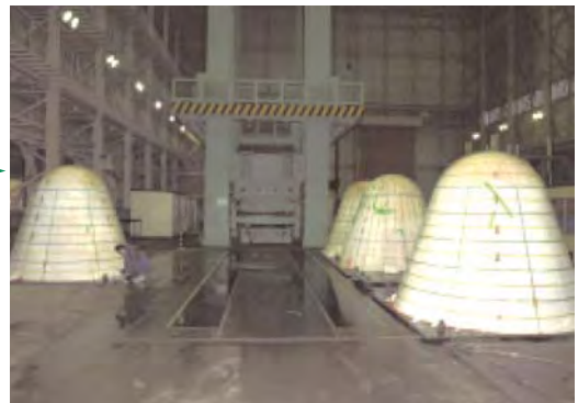
【30MN大型構造部材万能試験機の部外者利用例】 船舶の殻構造物試験（写真は、試験準備中のもの）
