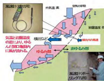
図-2 地中風速測定
