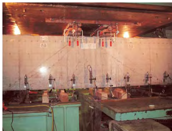
写真-1 大型RC部材を用いたせん断耐力評価実験
