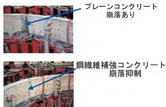
図-2 鋼繊維補強コンクリートの効果
