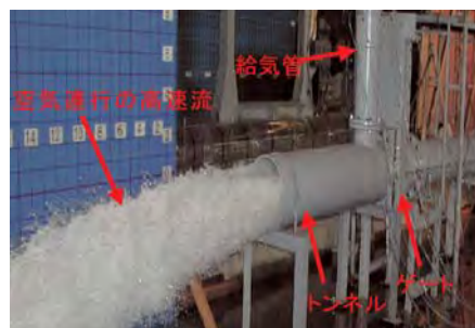
図-5 トンネル内放流設備の水理実験
