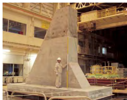
図-1 大型模型振動破壊実験
