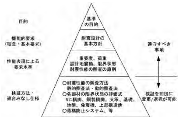
図-1 道路橋示方書V耐震設計編の性能照査型基本体系
