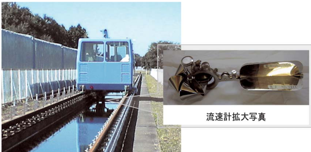
写真-1.4.1.3 流速計検定台車の全景と流速計の例
