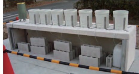
図-2 長期溶出試験装置
