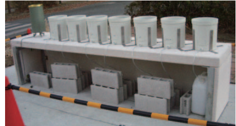
図-2 長期溶出試験装置
