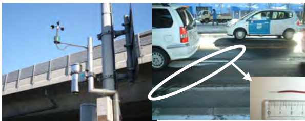
写真-2 気象観測（左）と路面温度観測（右）
