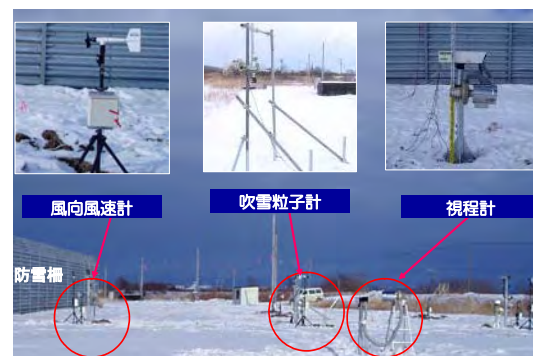
図-7.3 石狩吹雪実験場での防雪柵の計測
