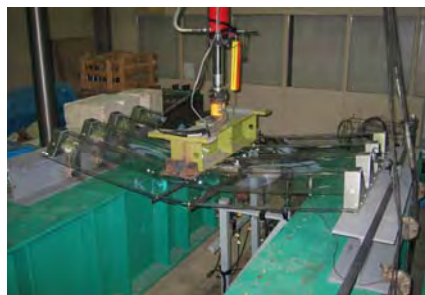
写真 新型越波柵の載荷実験状況
