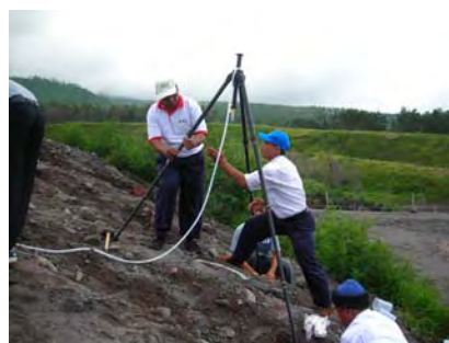
写真 現地浸透実験の状況
