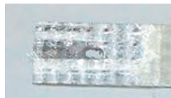
① FRP/FRP (材料破壊の傾向を示す)
