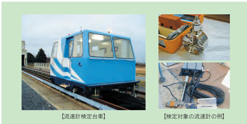
写真－2.4.1.4 流速計実験施設
