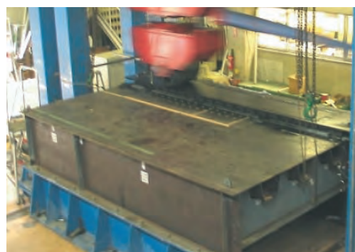
図-10.3 鋼床版試験体の輪荷重走行疲労試験
