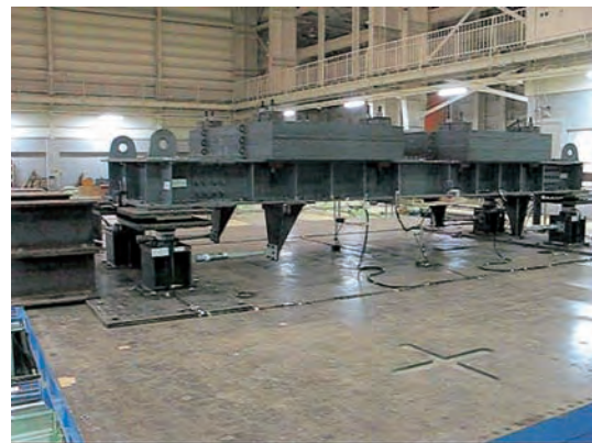
写真 模型橋の振動台実験状況
