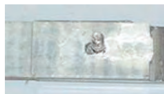
写真 ボルト/接着併用接合の静的破壊状況
