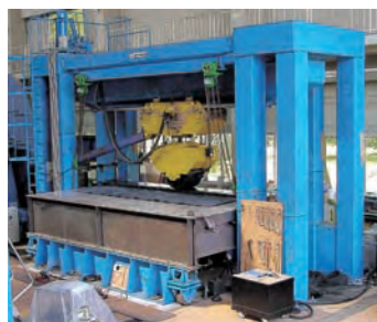
図-2 鋼床版試験体の輪荷重走行試験状況
