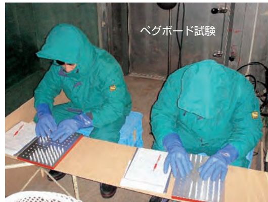
図-5.1 低温室における作業効率の被験者実験
