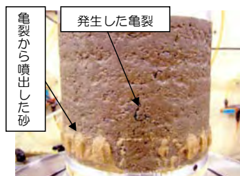
図 試験後の供試体の例
