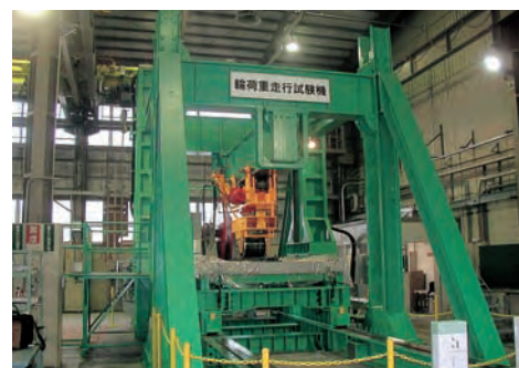
写真-11.2 輪荷重走行試験
