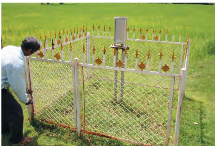
写真－1.6.1.3 現地における雨量観測の様子（カンボジア プルサット州ダッパー）
