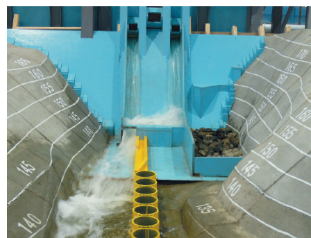
図-3 堤内仮排水路水理模型実験
