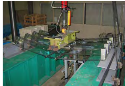
写真 新型越波柵の載荷実験状況
