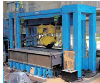
図-2 鋼床版試験体の輪荷重走行試験状況
