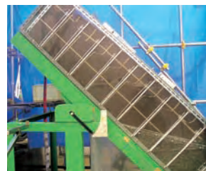
図 斜面崩壊模型実験の様子
