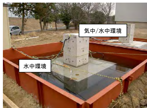
写真 フーチング供試体の暴露試験状況
