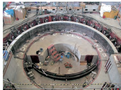
図-10.4 トンネル覆工載荷実験
