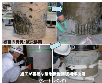
図 3.5 振動台実験による迅速応急復旧工法の効果検証
