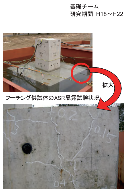
ASRによってフーチング部に発生したひび割れ
