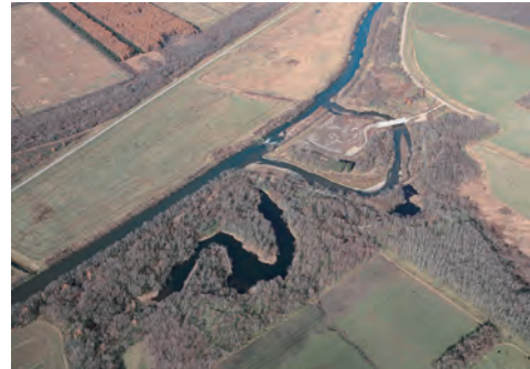
写真 15.1 直線化した河道、旧川周辺の大規模農地及び蛇行復元試験（国土交通省提供）
