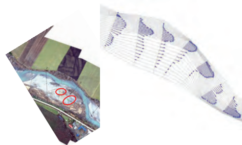
流木堆積箇所と流速ベクトル
