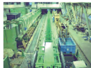
図 1.8 複断面水路の実験装置
