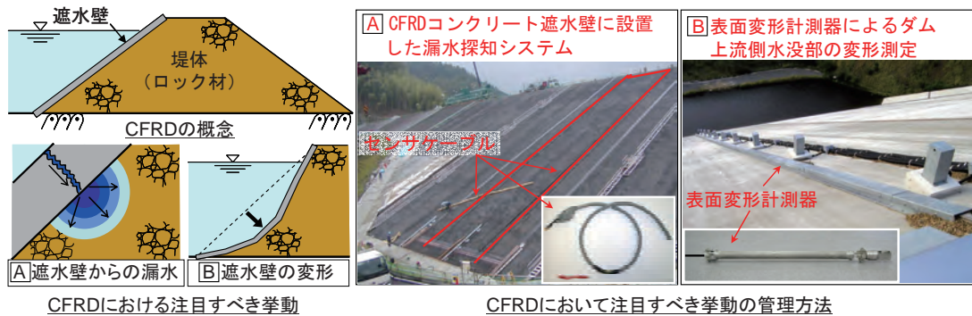
図－1 新型ダムであるCFRDに対する安全管理手法の開発
