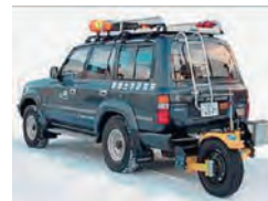
写真 7.5 連続路面すべり抵抗測定装置 (RT3)
