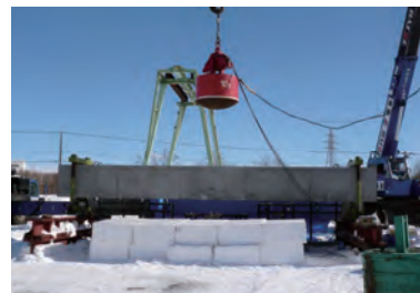
写真 6.4 RC 梁衝撃実験状況
