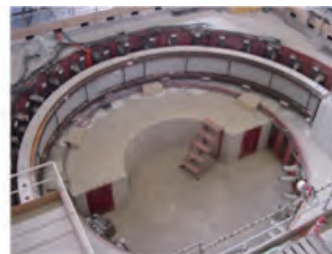
図 10.6 トンネル変状対策工载荷実験
