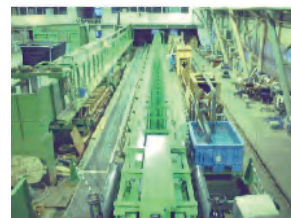
図 1.8 複断面水路の実験装置
