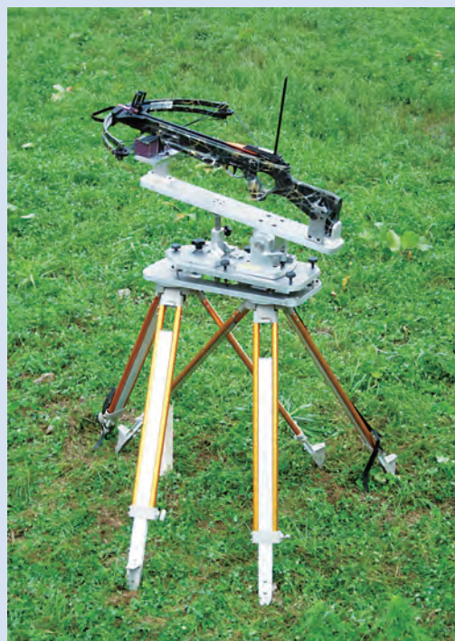
写真-1 RE・MO・TE2の発射装置
