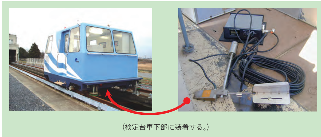
写真－2.4.1.4 流速計実験施設
