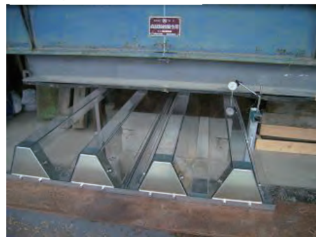
新型越波柵の載荷実験状況
