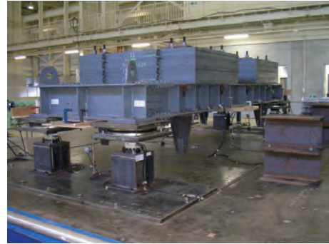
すべり摩擦力と変位制御機構を有するすべり支承を用いた模型橋の振動台実験
