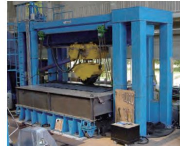
図-1 輪荷重走行試験状況
