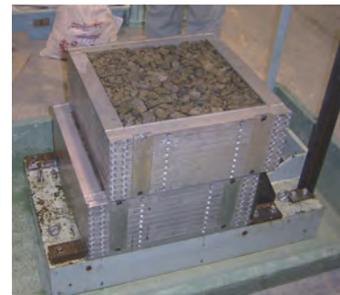
大型一面せん断試験実施状況
