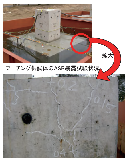
ASRによってフーチング部に発生したひび割れ
