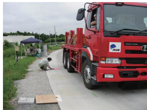
写真 9.1 静的荷重試験
