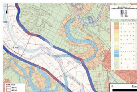
図 2.5 基礎地盤漏水ポテンシャル図
