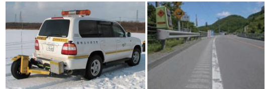
写真 7.5 連続路面すべり抵抗値測定装置 写真 7.6 路肩に設置されたランプルストリップ
