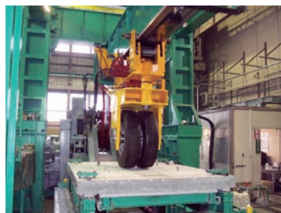
写真 11.5 補強 RC 床版の輪荷重走行試験状況
