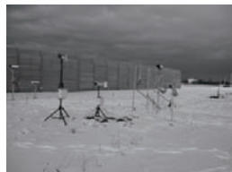
写真 7.11 防雪柵の実物フィールド実験
