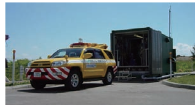
バイオガス充填状況
