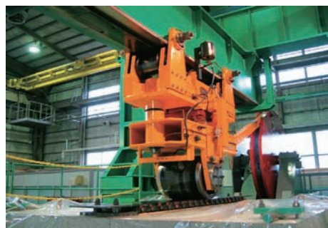
写真 11.3 凍害などの影響を受けた RC 部材の疲労劣化に関する実験
