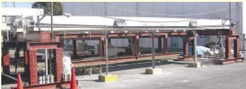
写真 - 3 断面修復後外ケーブル補強を施した試験供試体
