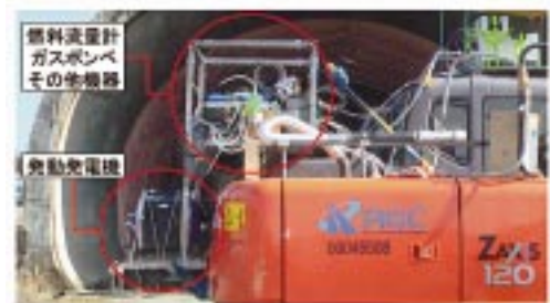
排出ガス測定機器の搭載状況
