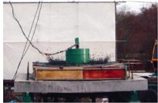
写真6.3 RCスラブ衝撃実験状況
