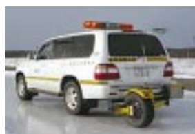
写真7.5 連続路面すべり 抵抗値測定装置
