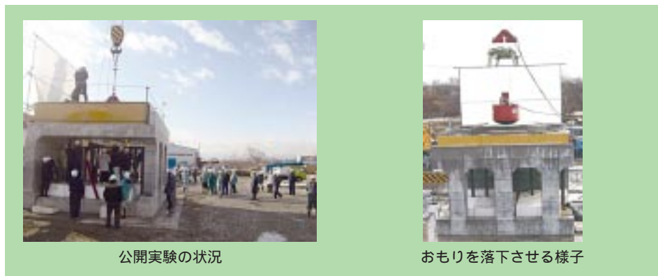
写真 - 1.5.17 覆道模型への衝撃載荷実験
