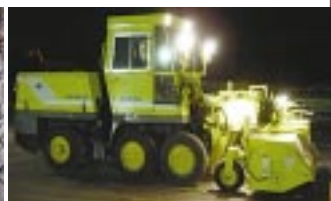
写真7.13 ブラシ式路面処理装置
