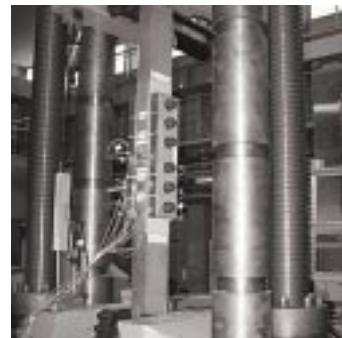
厚板鋼板ボルト試験体の引張試験状況
