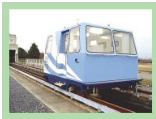
写真 - 2.4.4 流速計検定施設
