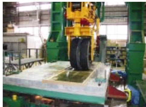
写真116 RC床版の移動載荷試験状況
