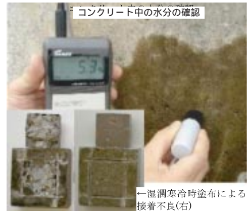
図105 被覆系補修材料の施工環境と接着性の評価試験
