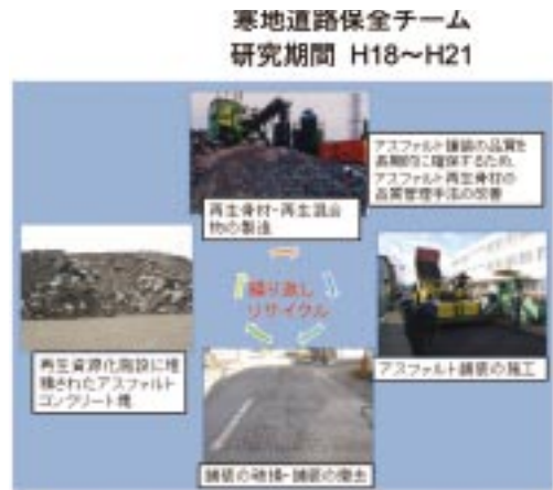
アスファルト舗装材料のリサイクル
