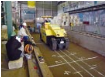
図 - 1 施工機械の校正試験
