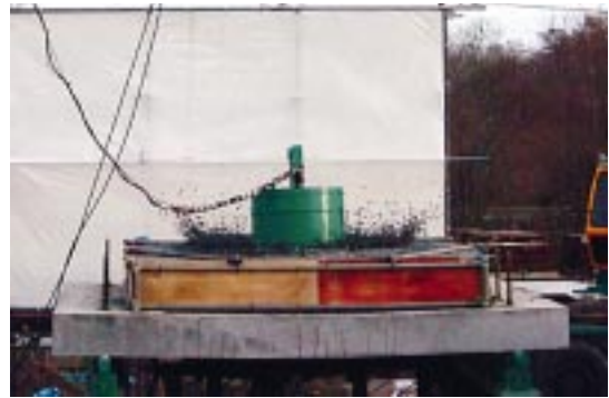
写真6.3 RCスラブ衝撃実験状況
