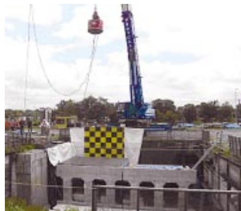
写真6.4 RC覆道の全体系模型を用いた衝撃実験状況
