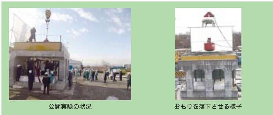
写真 - 1.5.17 覆道模型への衝撃載荷実験
