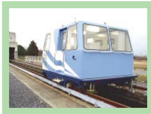
写真 - 2.4.4 流速計検定施設
