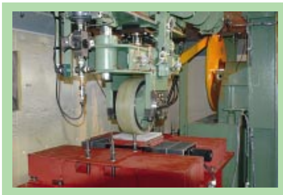
写真 - 7.1.1 凍害用ランダム走行試験施設
