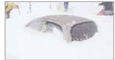
吹きだまりによる排気管閉塞状況
