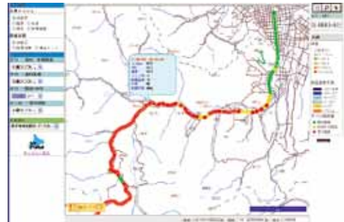
図7.3 冬期路面すべり抵抗モニタリングシステム
