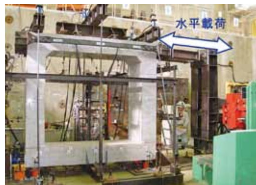
正負交番載荷実験状況写真
