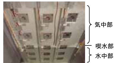
写真17.1 頭首工の現地条件を模擬した温冷繰り返し試験
