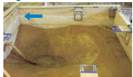
図14.9 排砂実験後(排水後)の状況
