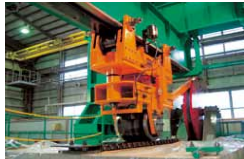
写真11.3 凍害などの影響を受けたRC部材の疲労劣化に関する実験
