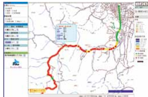
図7.3 冬期路面すべり抵抗モニタリングシステム
