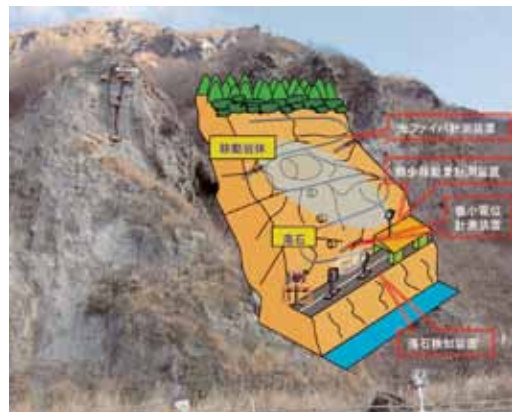
図6.1 多様な計測機器を用いた岩盤調査
