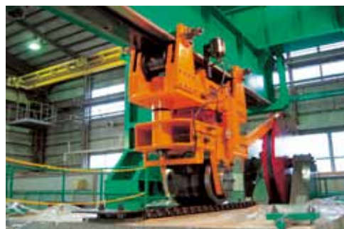
写真11.3 凍害などの影響を受けたRC部材の疲労劣化に関する実験
