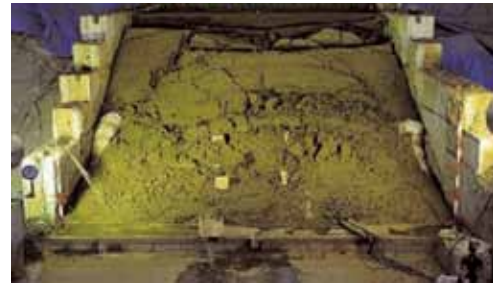
図2.5 模型堤防の変状状況(すべり)
