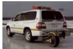
写真7.5 連続路面すべり抵抗値測定装置
