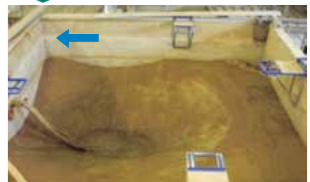
改良後：土砂の吸引は最後まで継続。洗掘深1.9m 図14.9 排砂実験後(排水後)の状況
