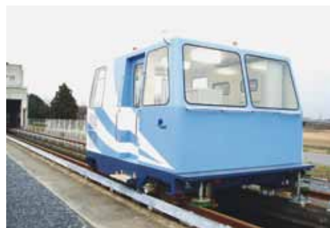
写真-2.4.4 流速計検定施設
