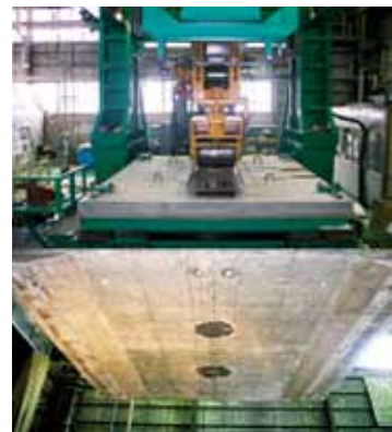
模擬損傷床版の輪荷重走行試験
