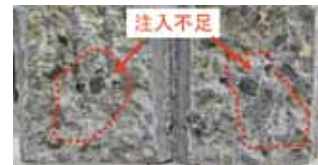
室内実験による注入不足の一例
