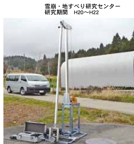
集水井内点検カメラ
