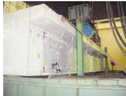
側面に鋼板接着された実大鉄筋コンクリート桁のせん断試験
