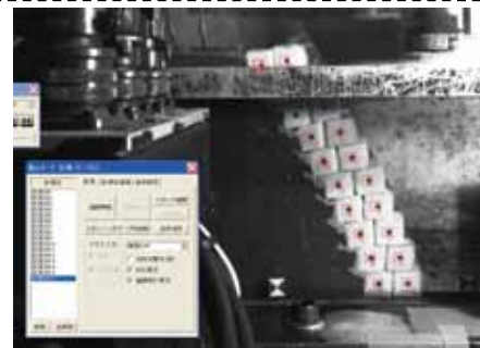
図 大型土のうの遠心模型実験の様子
