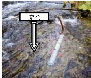
浮遊土砂調査の様子
