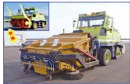
ロータリ除雪車に対応した路面清掃装置（試作機）
