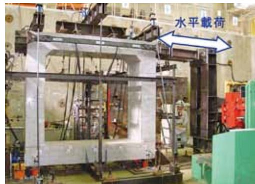
正負交番載荷実験状況写真
