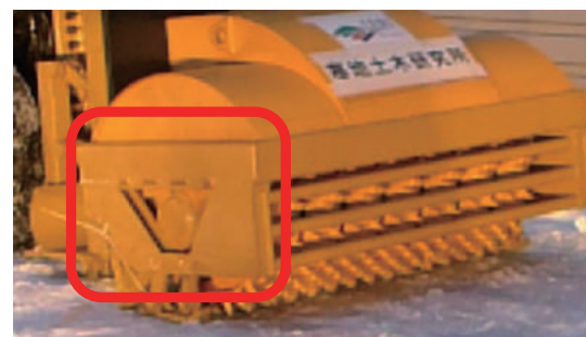
図-16.13 雪氷路面処理装置破碎部の改良
