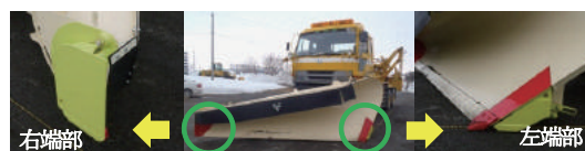
衝撃緩衝装置及び試験状況
