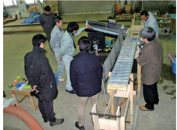
土石流メカニズムに関する実験の様子
