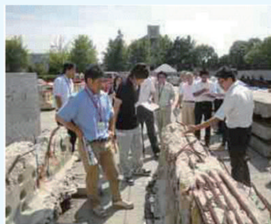
写真-2 塩害により腐食した橋の撤去部材の見学
