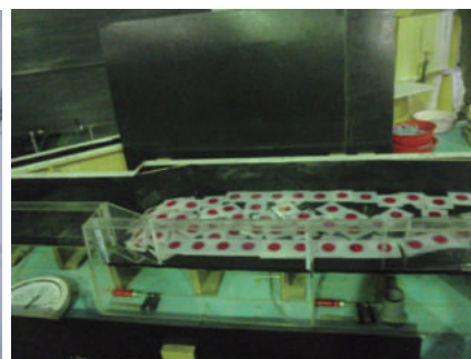
図：真勲別頭首工における現地調査(左)およびアイスジャム水理模型実験(右)
