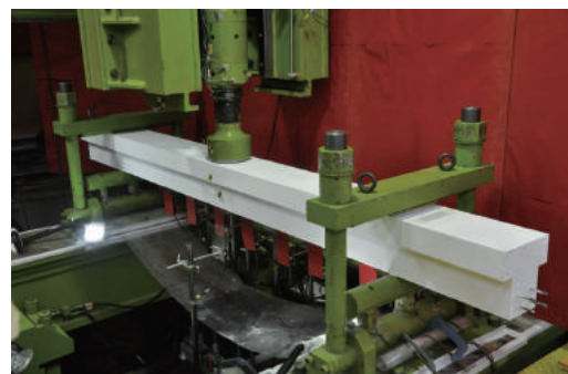
小型 PC 梁の衝撃実験状況
