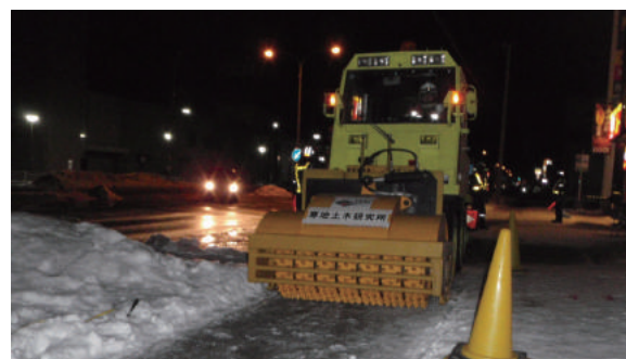
図-16.3 冬期歩道の雪氷路面処理技術
