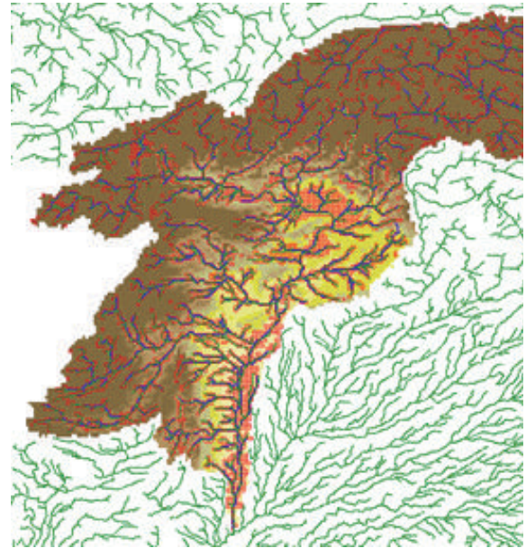
図-5.7 インターネット上で公開されている河道網データ(全域の緑線)をもとに、IFASの河道モデル(流域内の青線)を作成する機能(インダス川事例)
