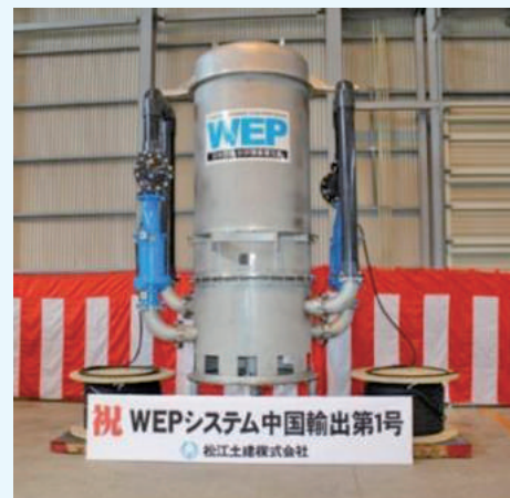
写真-1 中国に設置される気液溶解装置
