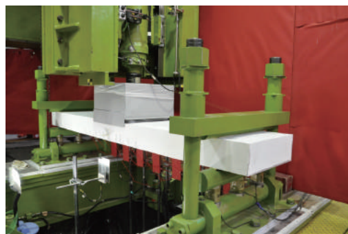
敷砂を設置した RC 梁衝撃実験
