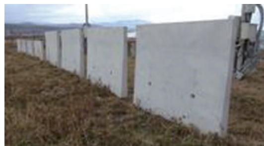
大型供試体暴露試験
