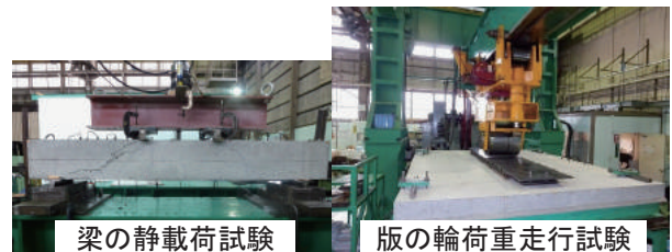
ラチス鉄筋を用いたせん断補強供試体の試験状況
