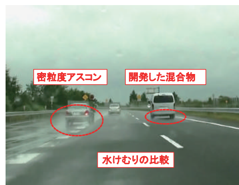
開発した混合物の雨天時の状況
