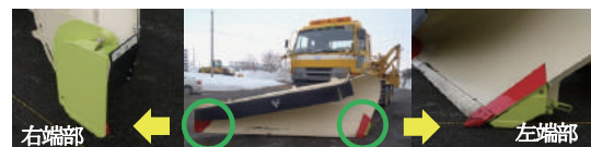
衝撃緩衝装置及び試験状況
