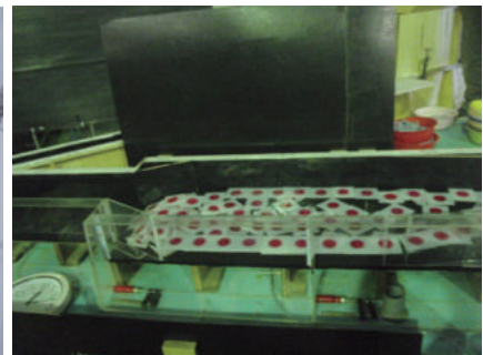
図：真勲別頭首工における現地調査（左）およびアイスジャム水理模型実験（右）
