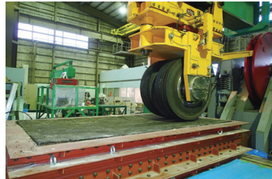
輪荷重走行試験機による舗装損傷度実験
