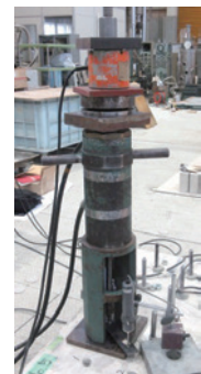
引張荷重と変位の関係 引張試験の実施状況 収縮量や保水能力の異なる無機系接着剤を用いた接着系あと施工アンカーの引張試験
