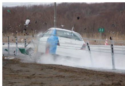
図-16.10 連結材性能確認試験
