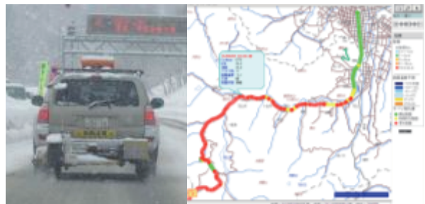
図-16.2 連続路面すべり抵抗値測定装置(CFT)およびモニタリング結果の例
