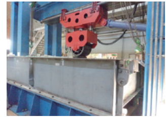
輪荷重走行試験状況
