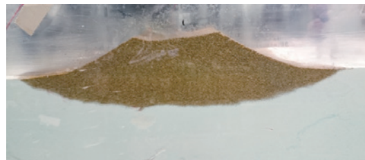
500gal 加振後の変形（無対策）
