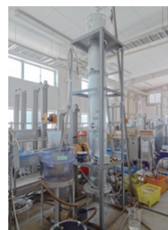
散水ろ床実験装置の外観
