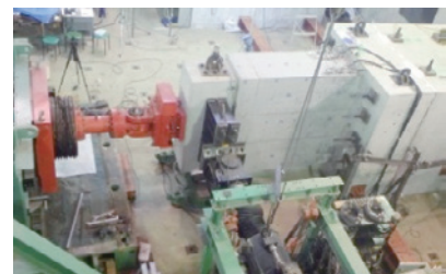
高強度鉄筋を用いた RC 巻立て補強された壁式橋脚模型の正負交番載荷実験
