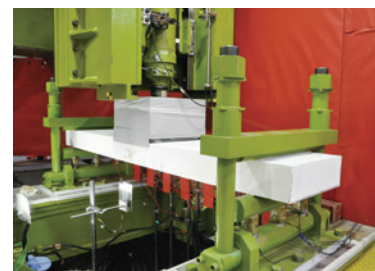
扁平 RC 梁の衝撃載荷実験状況
