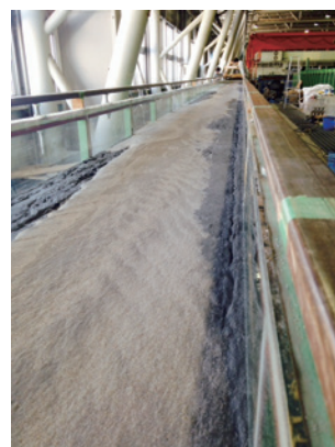
砂州が形成される岩盤河川の 水理模型実験
