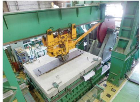
床版供試体を用いた 輪荷重走行試験の状況
