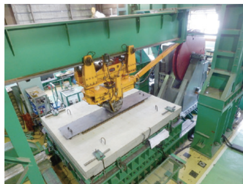
床版供試体を用いた輪荷重走行試験の状況
