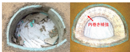
(a) 補強なし (b) 補強あり
