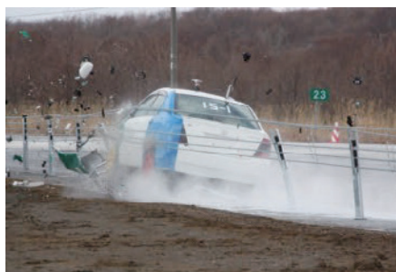
図-16.10 連結材性能確認試験
