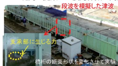
図-3.5 津波作用の検討のための実験装置
