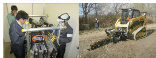
▲左) 管路供試体の通信性能計測状況 右) 掘削機械の試験施工状況
