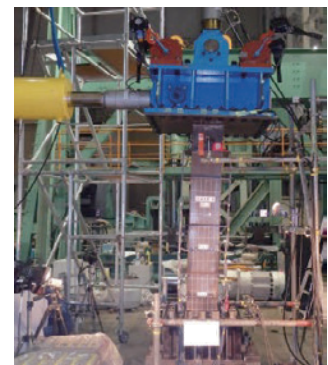
鋼部材の正負交番荷重実験
