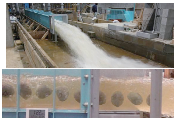
流速約 8m/s の水流が流れる水路の流況(上) と高速撮影で捉えた石が流下する状況(下)
