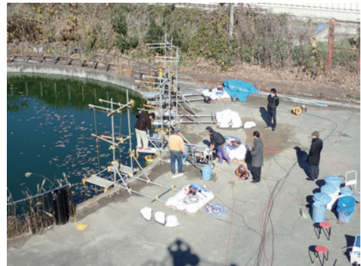
大水深凝集沈殿実験の様子
