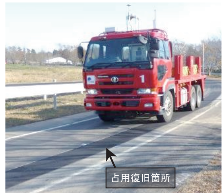
実大供試体による促進載荷試験状況
