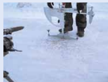
写真-3 砂を散布した路面でのすべり抵抗値の計測
