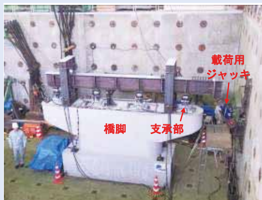
写真-3 津波の影響に対する支承部の抵抗特性に関する実験の状況
