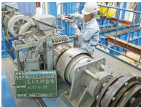
写真-8.1.4 輪荷重走行試験機の点検状況
