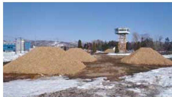
実験用雪山の全景 (雪山の表面に断熱材として伐採小木などを粉砕したパーク材を使用)
