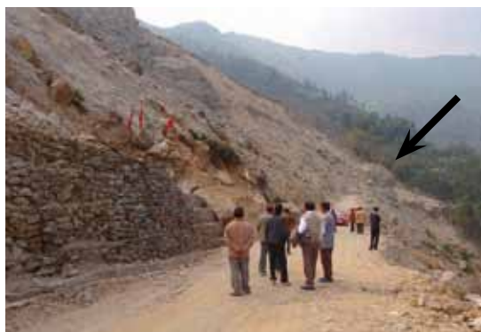
写真－1.2.9 地震による斜面崩落現場 (矢印部:巨礫が道に鎮座している)
