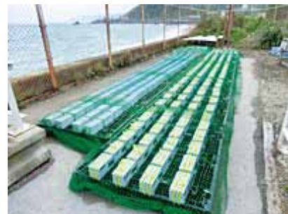
写真7.1 低炭素型セメントを使用したコンクリートの屋外暴露試験(沖縄)
