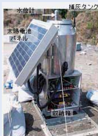
写真-1 自動降灰・降雨量計 特許第4915676号 共有権利者：日本工営株式会社
