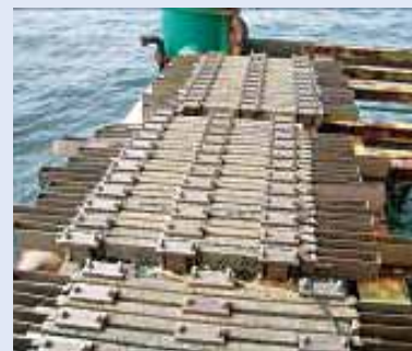
図-3 連続繊維補強材の暴露試験
