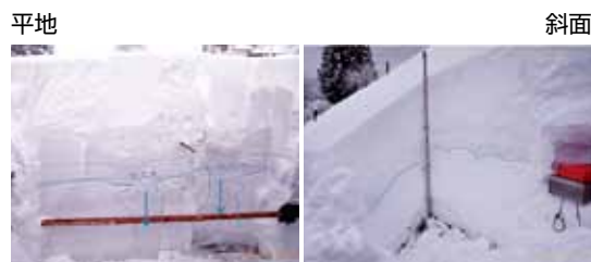
図4.9 積雪断面観測による水の浸透状況
