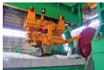
輪荷重走行試験状況
