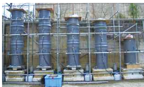
写真7.2 大型カラム試験装置 直径60cm、長さ最大3mの塩ビ管に掘削ずりを充填して、内部環境モニタリング、水質分析を行う。
