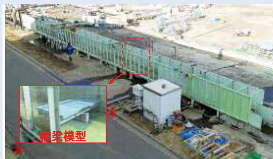
写真-1 橋梁模型の水路実験の状況
