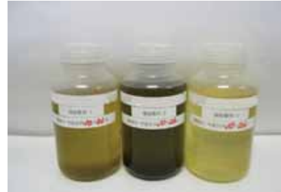
樋門開閉装置から採油した潤滑油(例)
