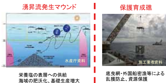
図12.3 物理環境改変のための土木構造物
