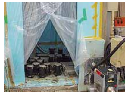
蒸気養生状況
