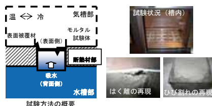
図 14.8 開発した凍結融解試験方法
