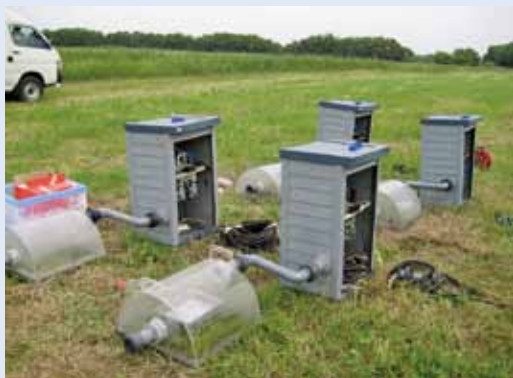
炭の散布の有無によるアンモニア揮散量比較試験
