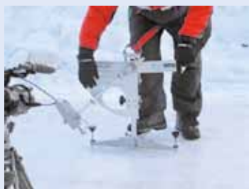
写真-2 凍結した路面でのすべり抵抗値の計測
