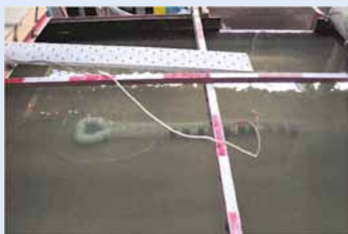
写真-1 潜行吸引式排砂管実験状況
