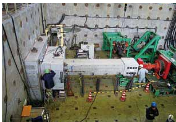
写真-1.3.9 鉄筋コンクリート橋脚模型の載荷実験
