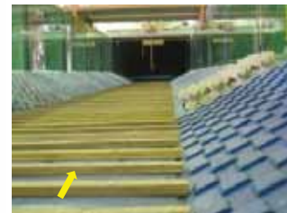
水理模型実験による根固めブロックの流速低減効果の確認
