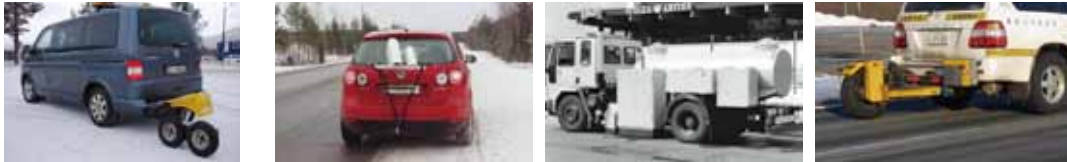
測定原理の異なる路面状態計測装置【左から：スリップ率式、光学式、横力式(SCRIM)、CFT】
