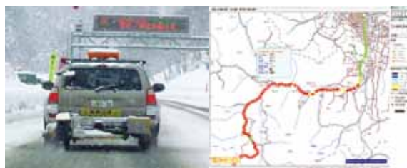
図16.1 連続路面すべり抵抗値測定装置及びモニタリング結果の例
