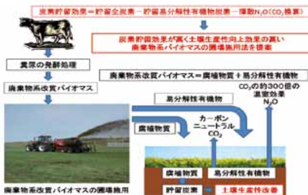
図6.2 廃棄物系改質バイオマスの大規模農地等への利用による土壌生産性改善技術
