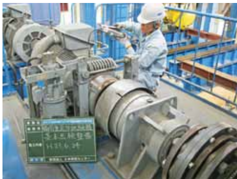
写真-8.1.4 輪荷重走行試験機の点検状況
