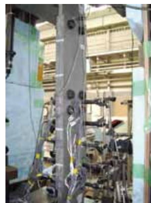
実大ボルト接着接合継手の引張試験
