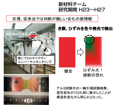
機能高分子材料を用いた構造物劣化検出の概要
