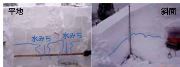
写真 4.2 積雪断面観測による水の浸透状況
