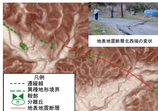
湯ノ岳断層北西端部の傾斜量図、地表地震断層の分布と判読された地形要素
