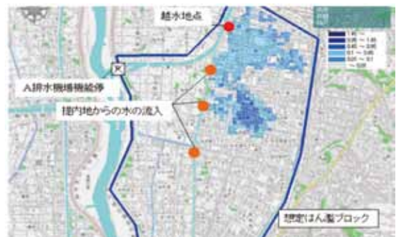
図 13.3 設備の状態と社会的影響度を考慮したストックマネジメント技術の確立（A排水機場故障により発生するはん濫のシミュレーション例）
