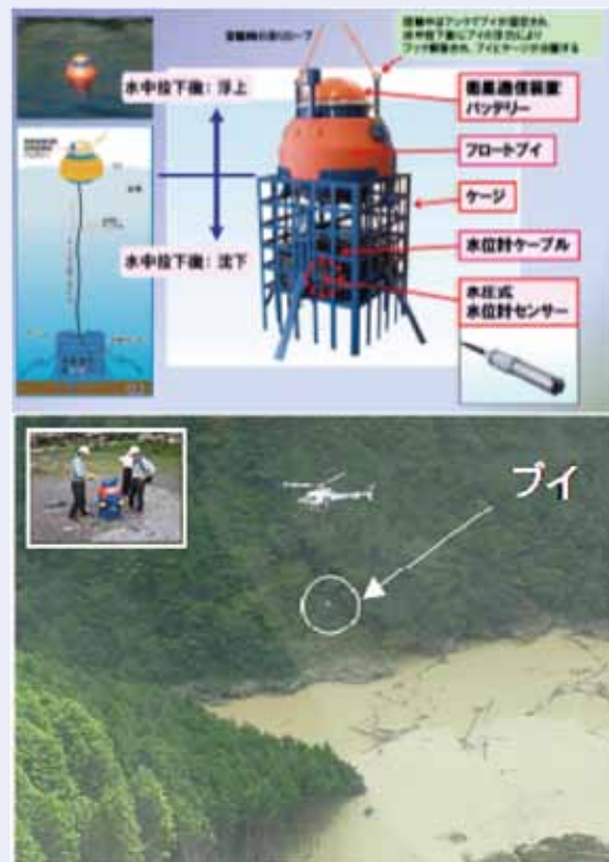
図-1 土研式投下型水位観測ブイの構造(上)と設置の様子(下)
