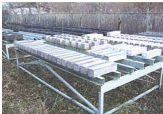
写真－8.1.1 暴露試験の状況（美々暴露試験場）
