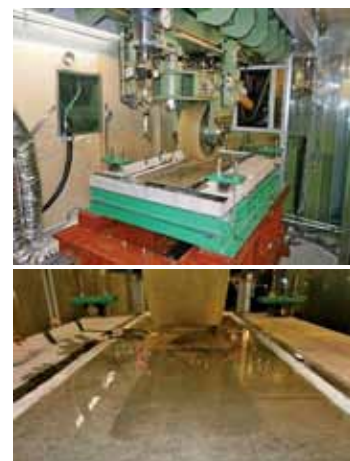
輪荷重走行試験状況
