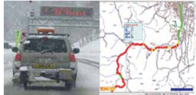
図 16.1 連続路面すべり抵抗値測定装置（CFT）およびモニタリング結果の例
