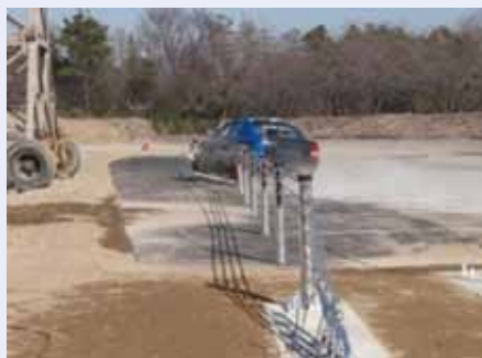
写真-1 防護柵の衝突試験
