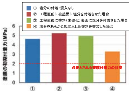
Rc-I 塗装系塗膜(はけ塗り)の初期付着力に及ぼす塩分の影響(塩分量150mg/m 2 程度)
