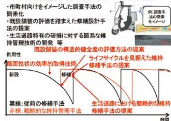
図 13.2 多様な管理水準・構造条件・損傷状態に応じた効率的な補修・補強技術の確立
