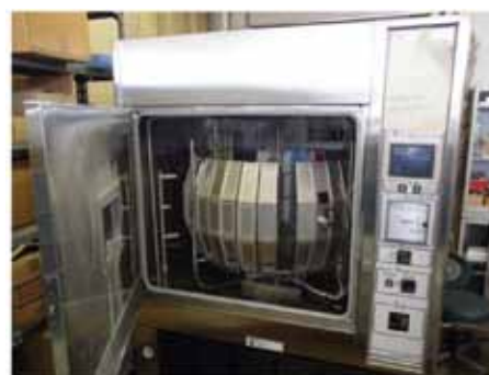
図 15.5 鋼橋塗装の促進耐候性試験（キセノンウェザーメーター）
