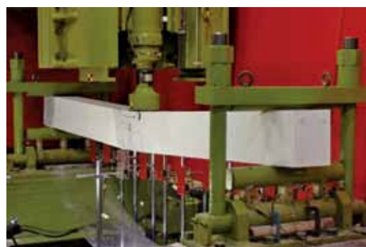
RC梁の衝撃実験状況
