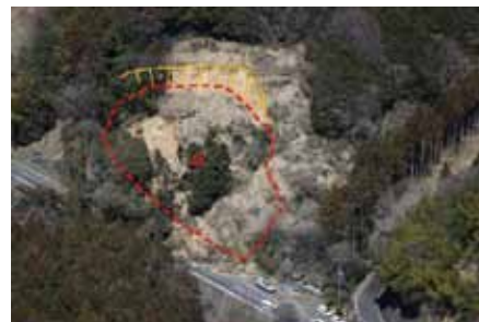
図 3.8 地震による斜面地盤変状の例 (流れ盤の地質構造によるすべり)
