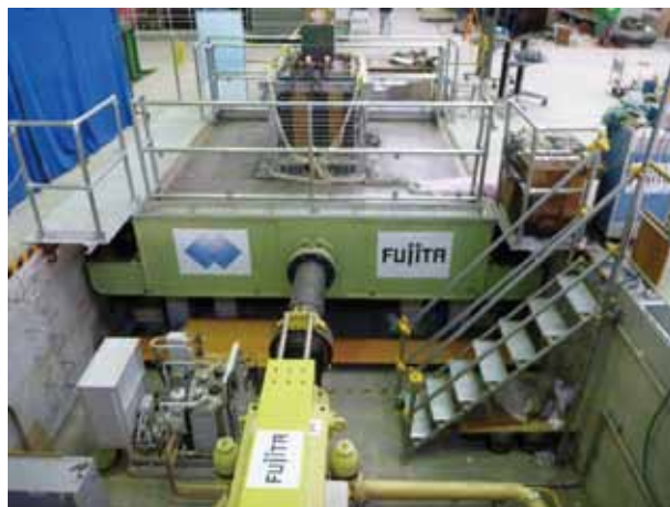
泥炭性軟弱地盤における既設杭の加振実験
