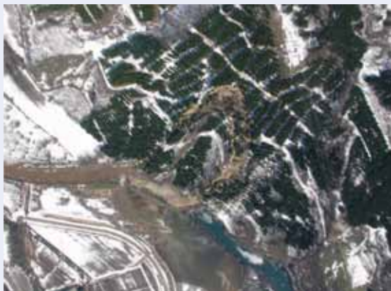
写真-1 地すべりに伴う河道閉塞箇所
