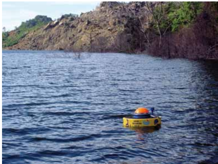
写真-1.2.4 現地に設置された土研式投下型水位観測ブイ
