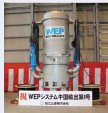
写真-1 中国で設置される気液溶解装置
