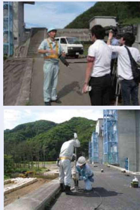
写真－2 取材対応風景（上）と重錘落下方式による振動計測状況（下）
