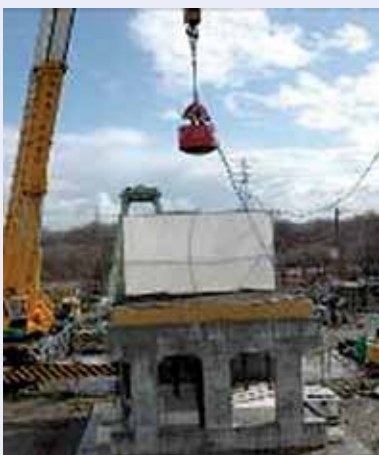
写真－1 1/2 覆工模型を用いた 既往の衝撃実験の状況
