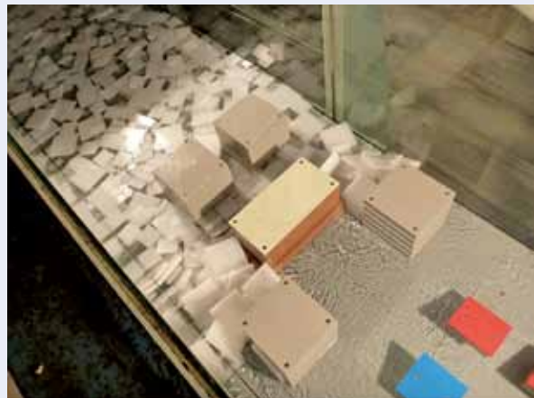
写真-2 模擬氷を用いた水理模型実験の様態
