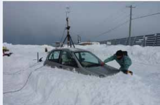
写真-2 試験時における車内CO濃度計測状況
