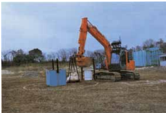
写真- 1.3.6 建設機械遠隔操作実験の状況
