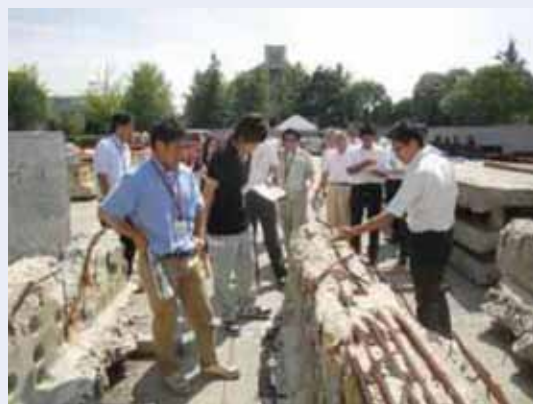
写真-2 塩害により腐食した橋の撤去部材の見学
