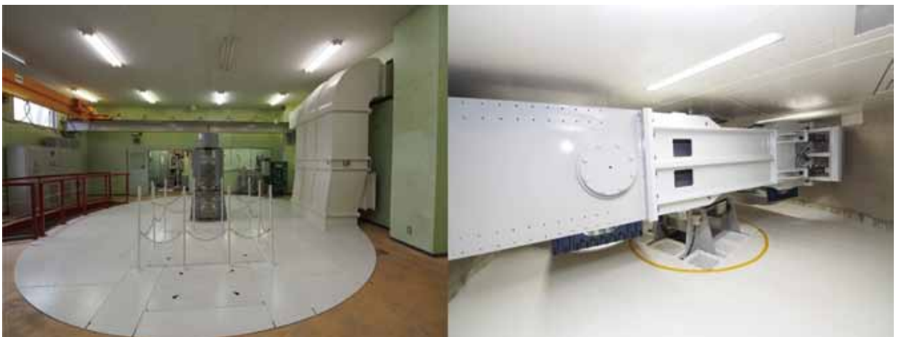
写真－ 8.2.1 遠心力载荷試験装置
