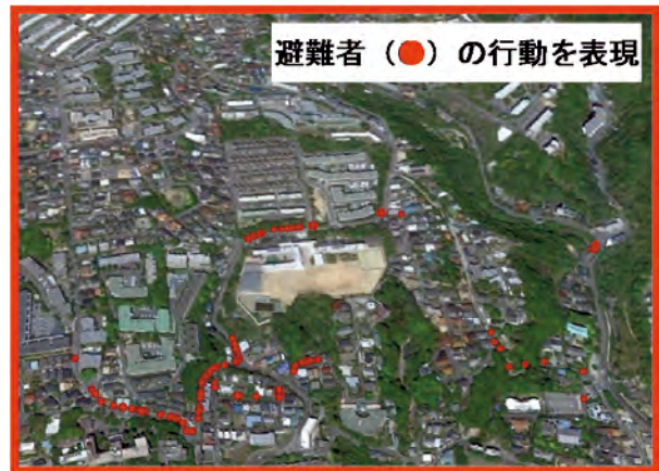
図-5.4 マルチエージェントモデルによる避難行動シミュレーションの事例
