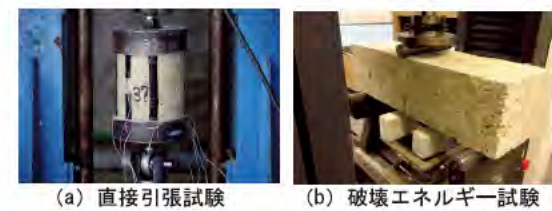
図-3.6 CSGの引張破壊特性の検討
