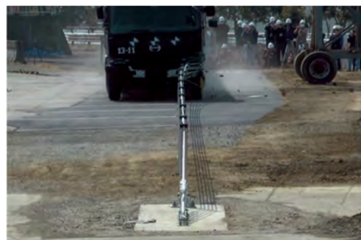
図-16.8 一般道路用柵の性能確認試験
