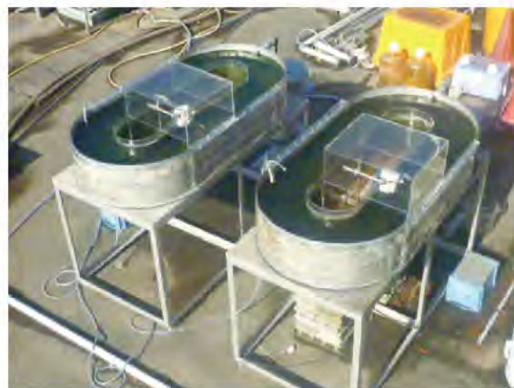
図-6.4 380L水槽による藻類の屋外培養実験
