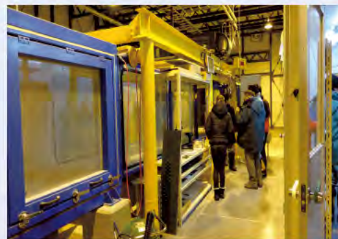
写真-4 吹雪室内実験装置を使った撮影
