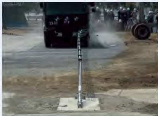
写真-2 大型車による衝突試験
