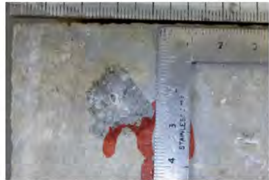
アルカリ量 2.2\text{kg}/\text{m}^3 の供試体のポップアウト
