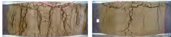
加振後の状況 左写真：基本ケース、右写真：盛土内水位低
